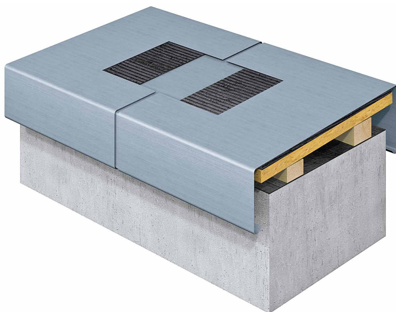
Szkic 24: Połączenie przesuwne na klej bitumiczny
