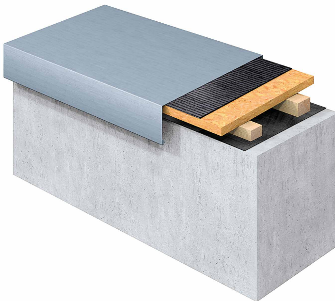
Szkic 15: Obróbka muru – mocowanie przy użyciu kleju bitumicznego
