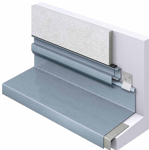
Szkic 25: Listwa kryjąca osadzona w listwie tynkowej
