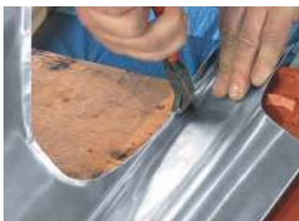
Przygotowanie rąbka kołnierza tylnego
