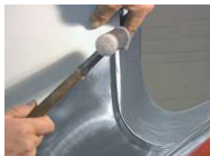
Doklepanie rąbka młotkiem plastikowym
