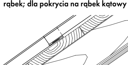
Połączenie poprzeczne: rąbek w rąbek; dla pokrycia na rąbek kątowy
