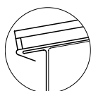
Zakończenie okapu stojące, proste (tylko dla miejsc, gdzie nie ma wymagań estetycznych dla takiej obróbki)
