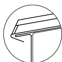
Zakończenie okapu stojące, ukośne
